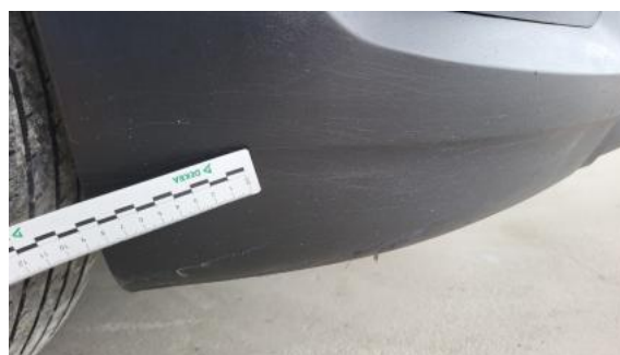
Fot. 48 Zderzak przedni cz dolna - Rysa/odprysk 2
