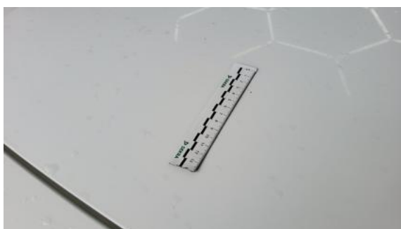
Fot. 43 Pokrywa komory silnika - Rysa/odprysk 1
