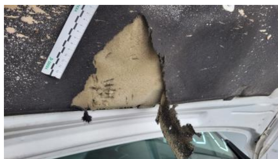
Fot. 44 Wykładzina pokrywy komory silnika - Pęknięcie/rozerwanie 1
