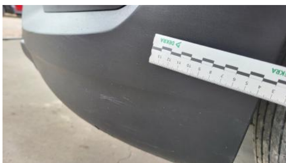
Fot. 47 Zderzak przedni cz dolna - Rysa/odprysk 1
