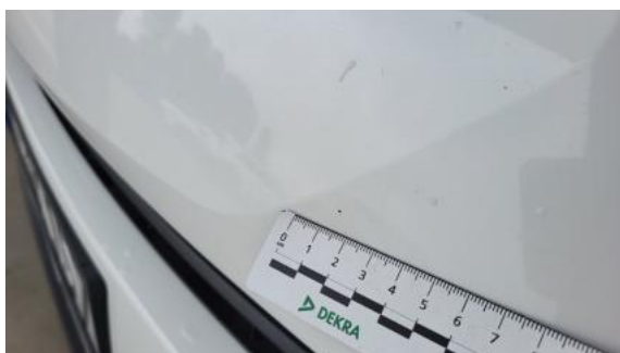
Fot. 45 Zderzak - Rysa/odprysk 1
