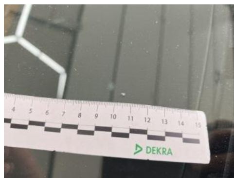
Fot. 44 Szyba czołowa - Rysa/odprysk 1
