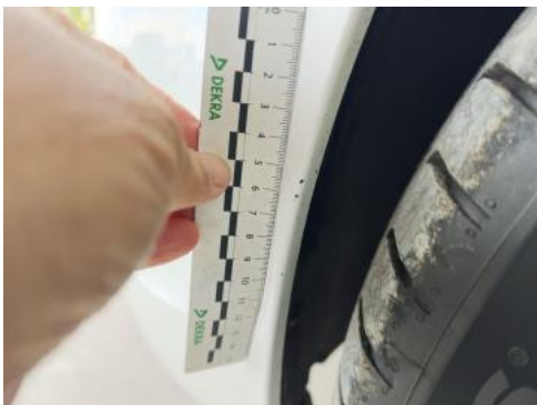
Fot. 49 Zderzak() - Rysa/odprysk 3
