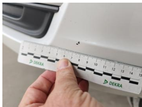
Fot. 48 Zderzak - Rysa/odprysk 2
