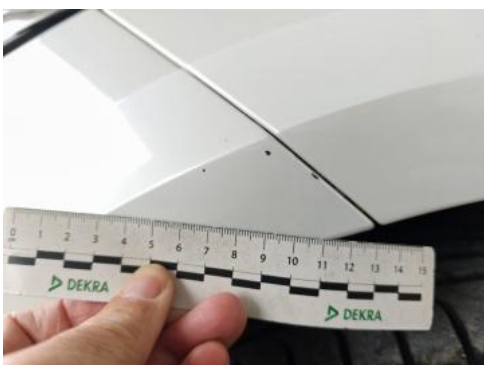
Fot. 47 Zderzak - Rysa/odprysk 1
