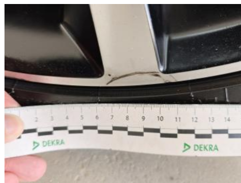
Fot. 54 Felga aluminiowa tylna P - Rysa/odprysk 1
