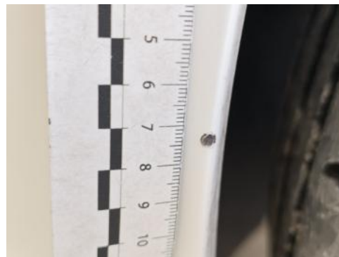
Fot. 50 Błotnik przedni P - Rysa/odprysk 1
