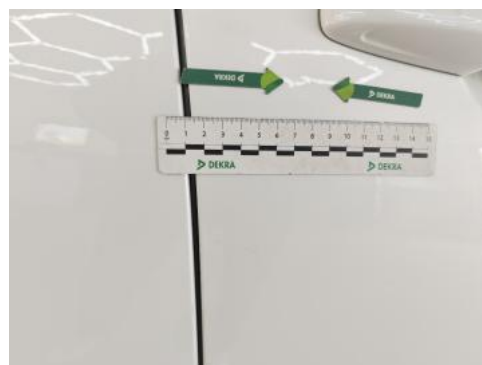
Fot. 52 Drzwi przednie P - Wgniecenie/odkształcenie 1
