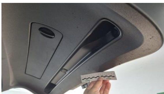
Fot. 55 Wykładzina pokrywy tylnej - Rysa/odprysk 1
