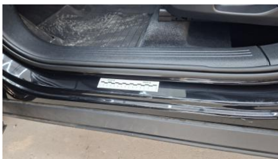
Fot. 53 Próg L - Rysa/odprysk 2
