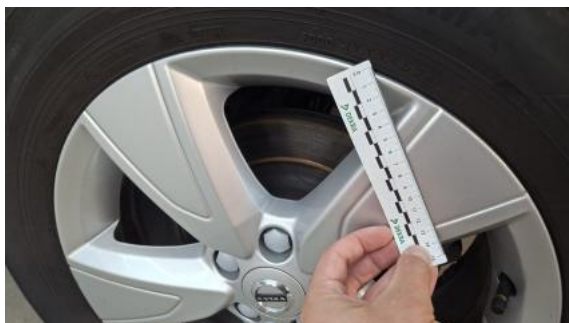
Fot. 49 Felga aluminiowa tylna L - Rysa/odprysk 1
