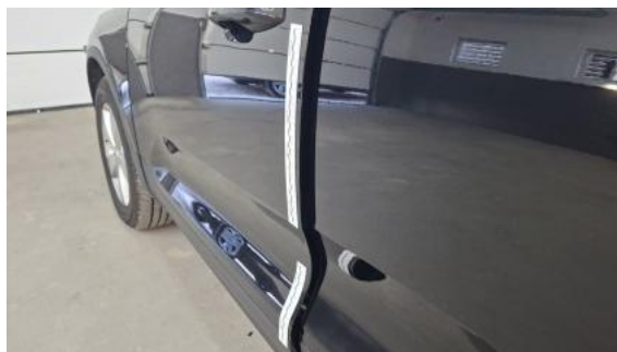
Fot. 50 Drzwi przed L - Rysa/odprysk 1
