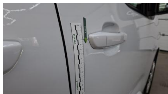
Fot. 40 Drzwi przednie P - Wgniecenie/odkształcenie 1
