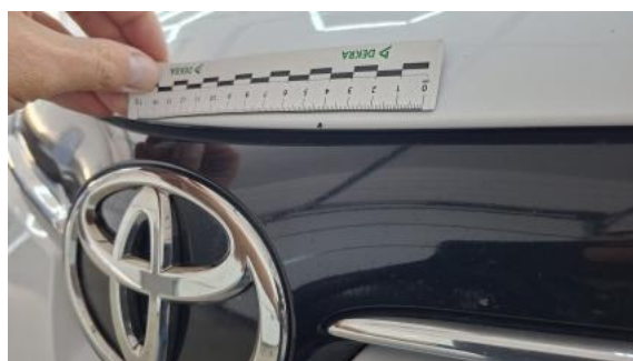
Fot. 39 Zderzak przedni cz górna - Rysa/odprysk 1
