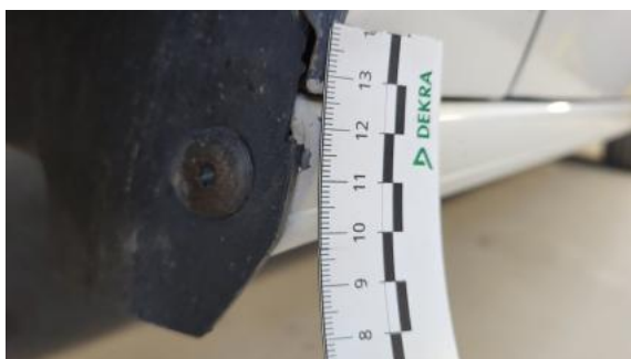
Fot. 77 Próg L - Rysa/odprysk 1
