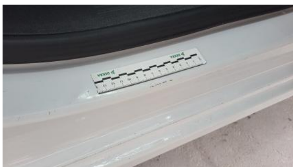
Fot. 61 Próg P - Rysa/odprysk 2
