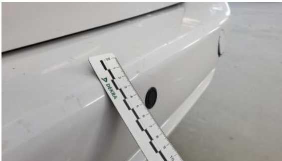
Fot. 69 Zderzak tylny - Wgniecenie/odkształcenie 1
