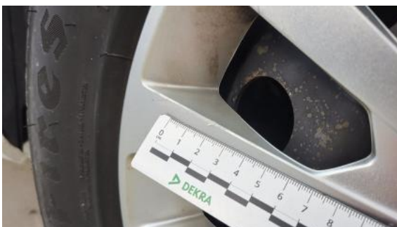
Fot. 71 Kołpak tylny L - Rysa/odprysk 1
