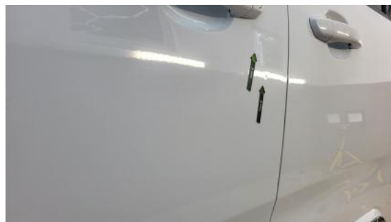
Fot. 74 Drzwi przed L - Wgniecenie/odkształcenie 1
