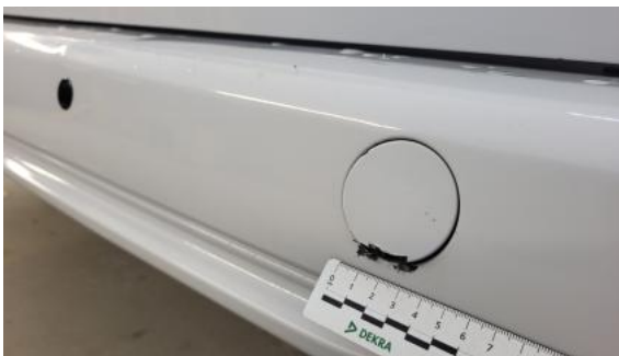
Fot. 67 Zderzak tylny - Rysa/odprysk 1
