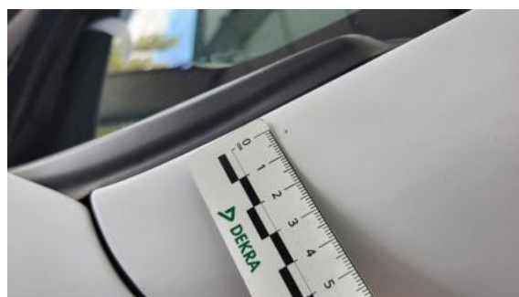
Fot. 80 Śłupek przedni L - Rysa/odprysk 1
