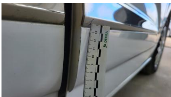
Fot. 59 Listwa drzwi przednich P - Rysa/odprysk 1
