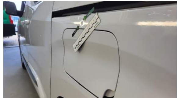
Fot. 70 Błotnik tylny L / Ściana boczna L - Wgniecenie/odkształcenie 1
