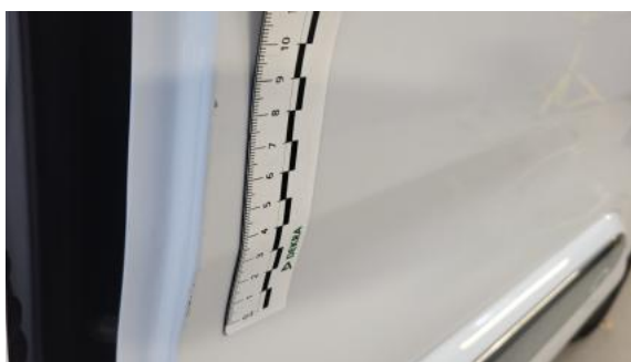
Fot. 75 Drzwi tylne L - Rysa/odprysk 1
