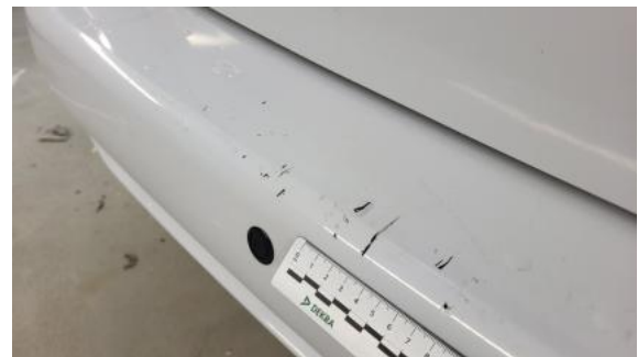
Fot. 68 Zderzak tylny - Rysa/odprysk 2
