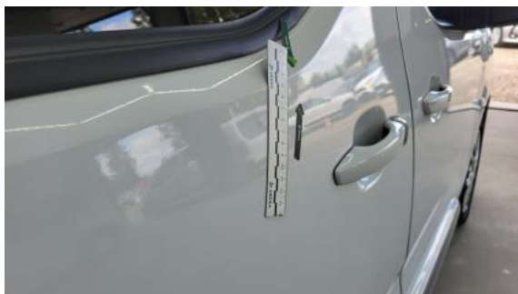
Fot. 57 Drzwi tylne P - Wgniecenie/odkształcenie 1
