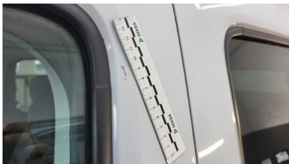
Fot. 73 Drzwi przed L - Rysa/odprysk 2
