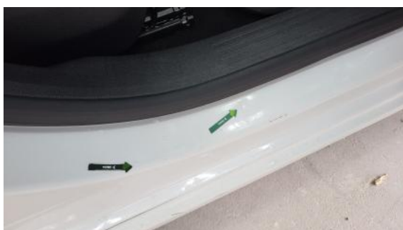
Fot. 63 Próg P - Wgniecenie/odkształcenie 1
