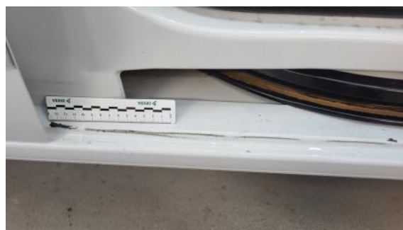
Fot. 78 Próg L - Rysa/odprysk 2
