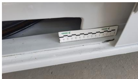
Fot. 62 Próg P() - Rysa/odprysk 3
