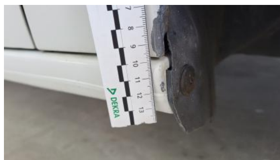
Fot. 60 Próg P - Rysa/odprysk 1
