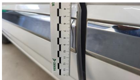
Fot. 76 Listwa drzwi przednich L - Rysa/odprysk 1
