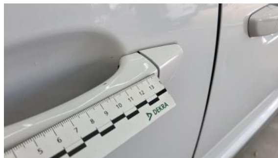
Fot. 58 Klamka drzwi tyl P - Rysa/odprysk 1
