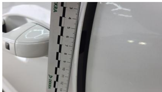
Fot. 50 Drzwi przed L - Rysa/odprysk 1
