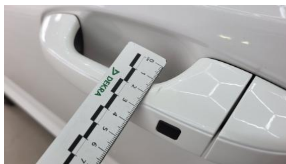
Fot. 52 Klamka drzwi prz L - Rysa/odprysk 1
