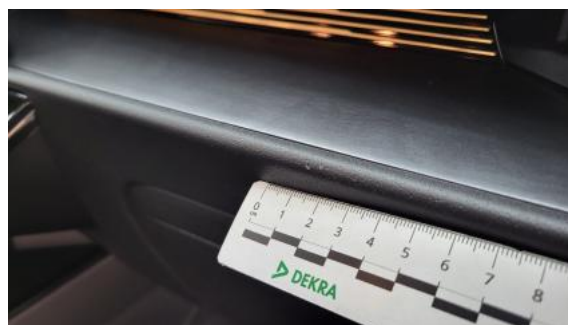
Fot. 54 Listwy deski rozdzielczej - Rysa/odprysk 1
