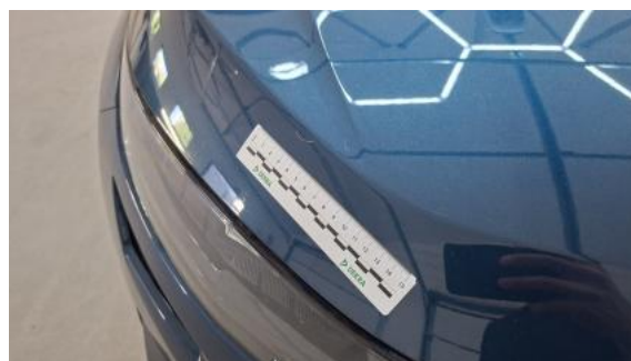
Pokrywa komory silnika - Rysa/odprysk 1
