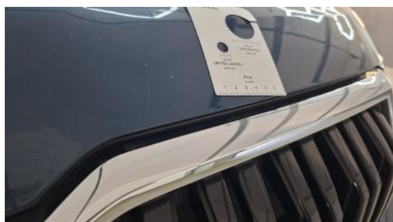
Pokrywa komory silnika - Rysa/odprysk 2
