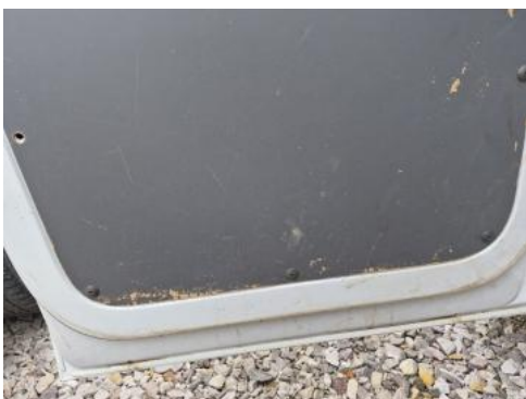
Fot. 61 Tapicerka drzwi tylnych L - Rysa/odprysk 1
