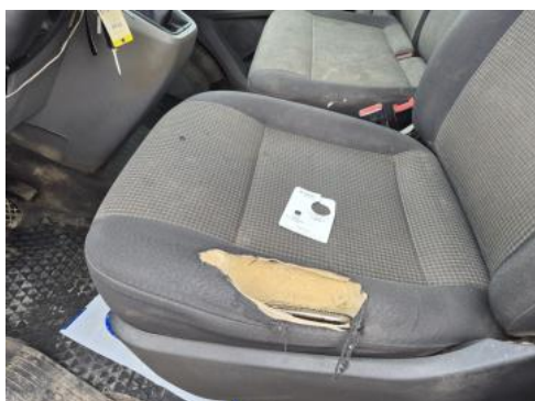
Fot. 55 Fotel prz. lew. - Pęknięcie/rozerwanie 1
