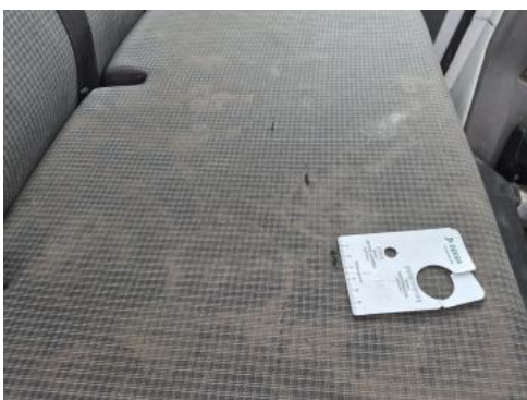
Fot. 59 Kanapa tyl. - Pęknięcie/rozerwanie 2
