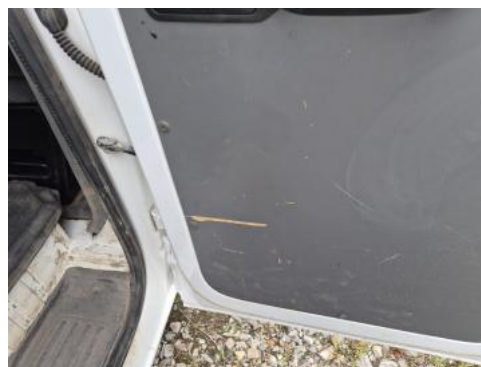
Fot. 62 Tapicerka drzwi tylnych P - Rysa/odprysk 1
