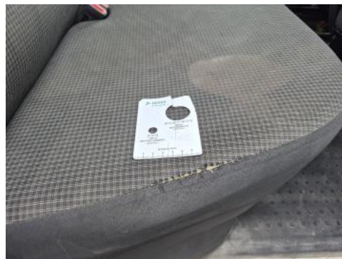
Fot. 58 Kanapa tyl. - Pęknięcie/rozerwanie 1
