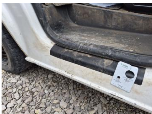
Fot. 51 Próg L - Rysa/odprysk 2
