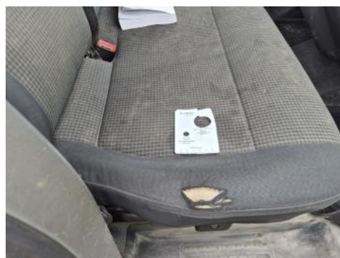
Fot. 56 Fotel prz. praw. - Pęknięcie/rozerwanie 1
