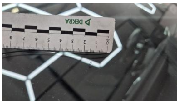
Fot. 39 Szyba czołowa - Pęknięcie/rozerwanie 1
