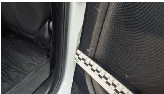
Fot. 75 Tapicerka drzwi tylnych P - Rysa/odprysk 1
