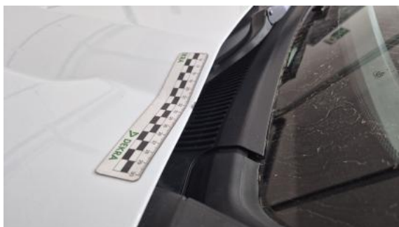
Fot. 37 Pokrywa komory silnika - Rysa/odprysk 2
