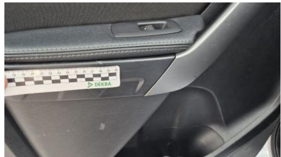
Fot. 74 Tapicerka drzwi tylnych L - Rysa/odprysk 2
