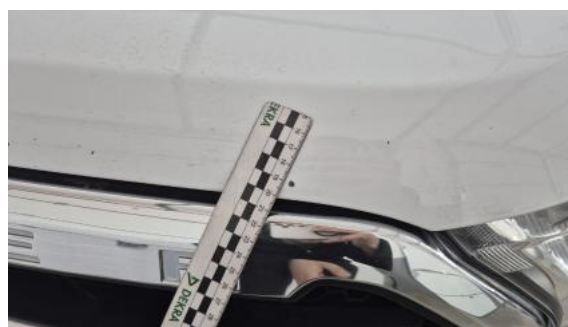
Fot. 36 Pokrywa komory silnika - Rysa/odprysk 1
