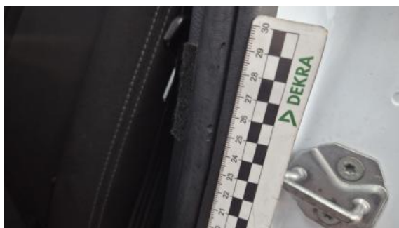
Fot. 77 Uszczelka drzwi tylnych L - Pęknięcie/rozerwanie 1
