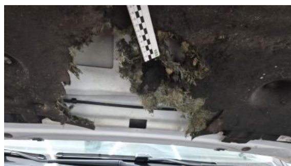
Fot. 40 Wykładzina pokrywy komory silnika - Pęknięcie/rozerwanie 1
