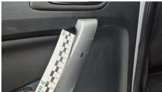
Fot. 73 Tapicerka drzwi tylnych L - Rysa/odprysk 1
