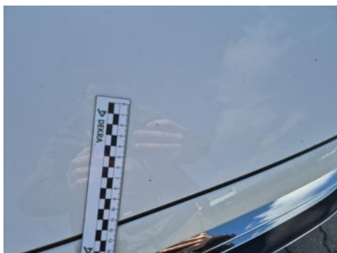
Fot. 33 Pokrywa komory silnika - Rysa/odprysk 1
