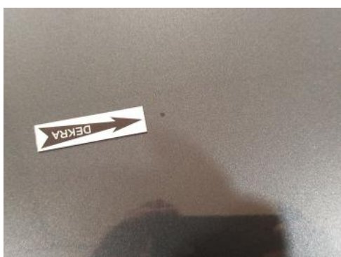
Fot. 39 Pokrywa komory silnika - Rysa/odprysk 2
