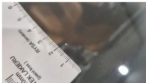
Fot. 38 Szyba czołowa - Rysa/odprysk 1
