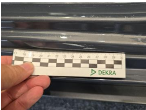
Fot. 53 Próg L() - Rysa/odprysk 3
