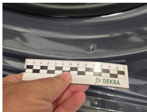
Fot. 52 Próg L - Rysa/odprysk 1
