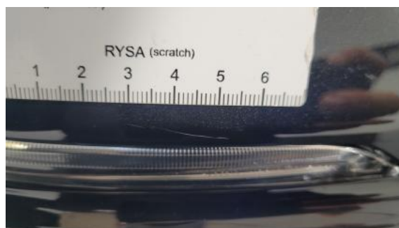
Fot. 36 Obudowa lusterka zew P - Rysa/odprysk 1
