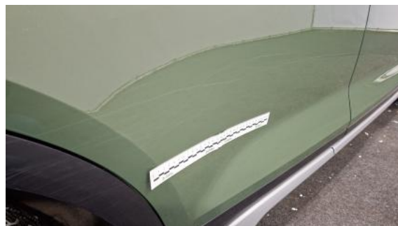
Fot. 50 Drzwi tylne P - Rysa/odprysk 1
