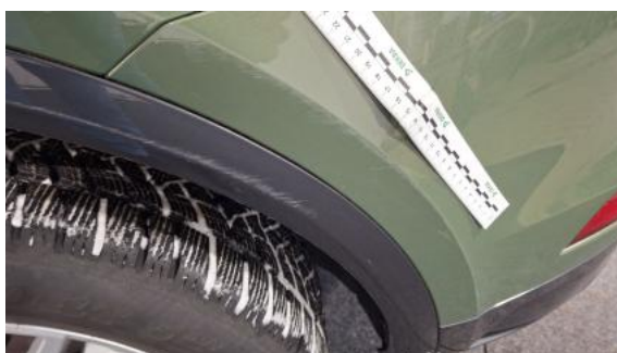
Fot. 55 Zderzak tylny cz L - Rysa/odprysk 1
