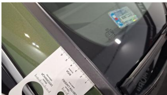
Fot. 37 Uszczelka/listwa szyby czołowej - Pęknięcie/rozerwanie 1
