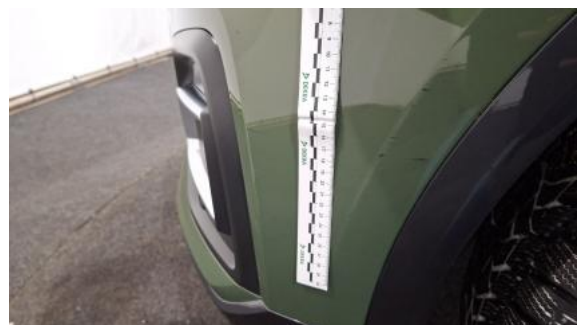
Fot. 38 Zderzak przedni cz L - Rysa/odprysk 1
