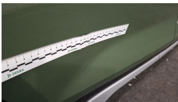
Fot. 51 Drzwi tylne P - Rysa/odprysk 2
