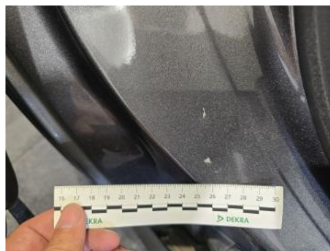
Fot. 50 Próg P - Rysa/odprysk 1
