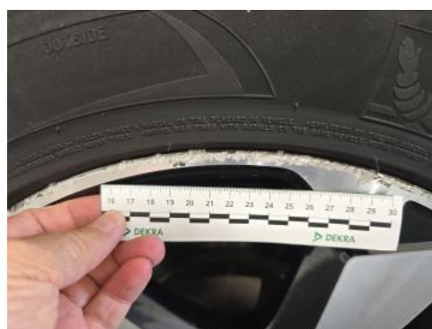
Fot. 52 Felga aluminiowa tylna P - Rysa/odprysk 1
