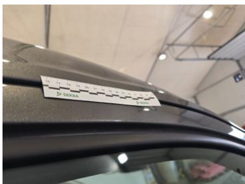
Fot. 59 Rama dachu P() - Wgniecenie/odkształcenie 3
