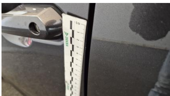
Fot. 47 Drzwi przed L - Rysa/odprysk 1
