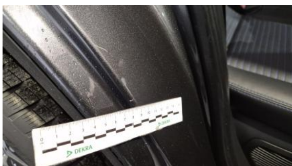
Fot. 43 Błotnik tylny P / Ściana boczna P - Rysa/odprysk 1
