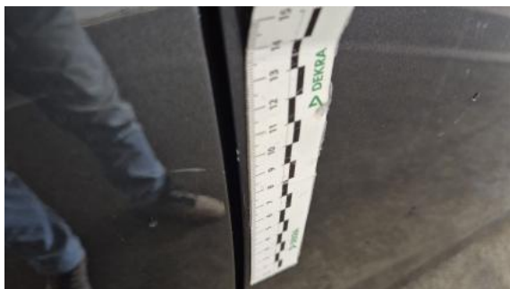
Fot. 41 Drzwi przednie P - Rysa/odprysk 1
