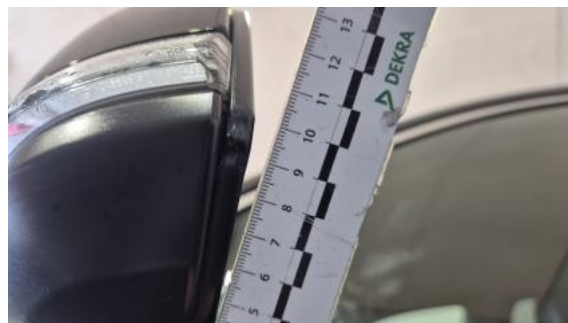
Fot. 50 Lusterko zew L - Wgniecenie/odkształcenie 1
