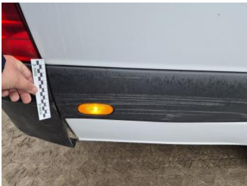
Fot. 51 Błotnik tylny P / Ściana boczna P - Pęknięcie/rozerwanie 2
