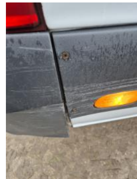
Fot. 52 Błotnik tylny P / Ściana boczna P() - Pęknięcie/rozerwanie 3
