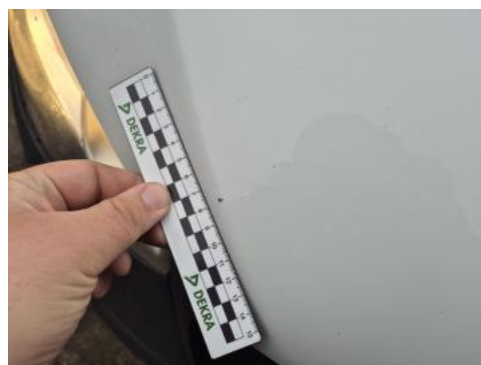
Fot. 32 Pokrywa komory silnika - Rysa/odprysk 2
