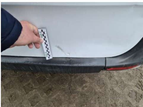
Fot. 55 Pokrywy bagażnika - Wgniecenie/odkształcenie 1
