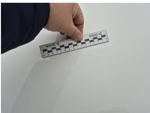
Fot. 31 Pokrywa komory silnika - Rysa/odprysk 1
