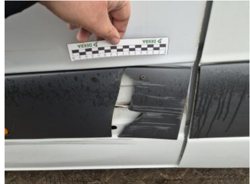
Fot. 50 Błotnik tylny P / Ściana boczna P - Pęknięcie/rozerwanie 1
