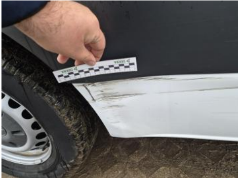
Fot. 49 Błotnik tylny P / Ściana boczna P - Wgniecenie/odkształcenie 2
