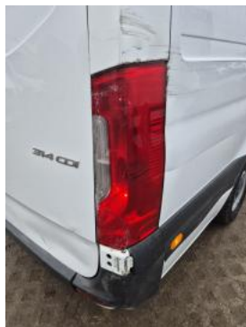
Fot. 53 Lampa zespolona tylna P - Pęknięcie/rozerwanie 1
