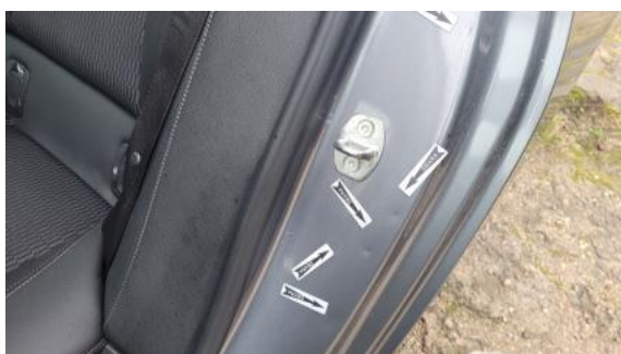
Fot. 47 Błotnik tylny L / Ściana boczna L - Rysa/odprysk 2
