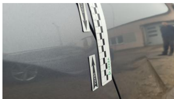
Fot. 44 Błotnik tylny P / Ściana boczna P - Wgniecenie/odkształcenie 2
