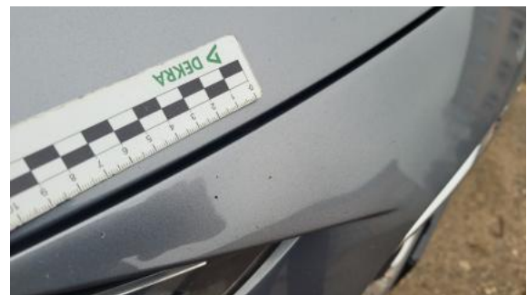
Fot. 38 Zderzak - Rysa/odprysk 1
