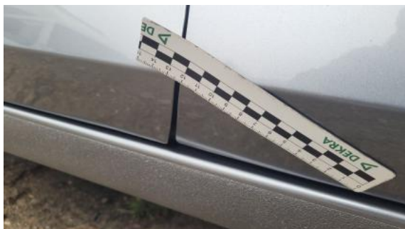
Fot. 41 Drzwi przednie P - Wgniecenie/odkształcenie 1
