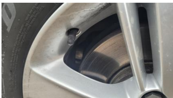
Fot. 29 Tarcza hamulcowa przednia prawa
