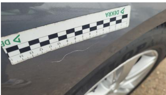
Fot. 39 Błotnik przedni P - Rysa/odprysk 1
