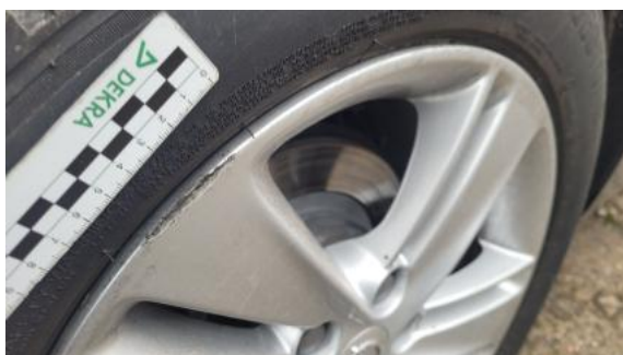
Fot. 45 Felga aluminiowa tylna P - Rysa/odprysk 1
