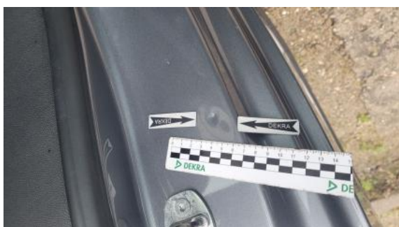
Fot. 43 Błotnik tylny P / Ściana boczna P - Wgniecenie/odkształcenie 1
