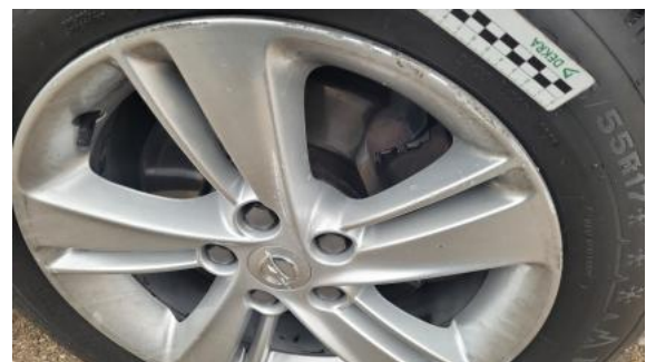
Fot. 40 Felga aluminiowa przednia P - Rysa/odprysk 1
