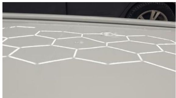
Fot. 38 Dach - Wgniecenie/odkształcenie 2
