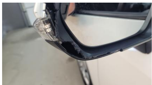
Fot. 40 Lusterko zew L - Pęknięcie/rozerwanie 1
