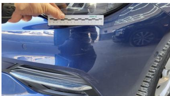
Fot. 39 Zderzak - Rysa/odprysk 1
