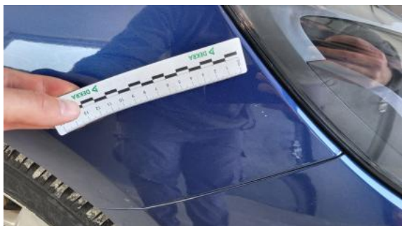
Fot. 41 Błotnik przedni P - Rysa/odprysk 1
