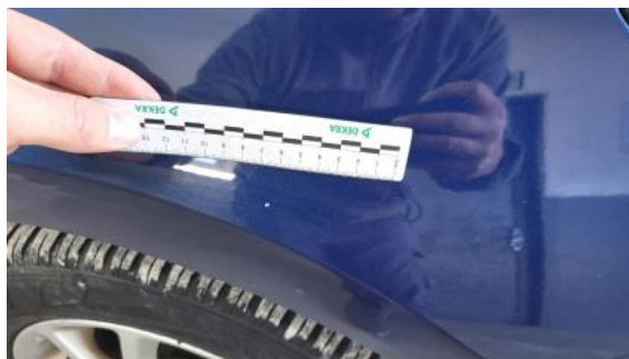
Fot. 42 Błotnik przedni P - Rysa/odprysk 2
