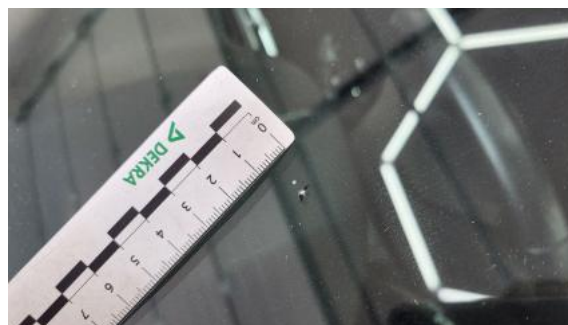
Fot. 38 Szyba czołowa - Pęknięcie/rozerwanie 1
