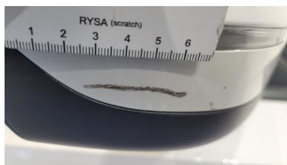
Fot. 36 Obudowa lusterka zew P - Rysa/odprysk 1
