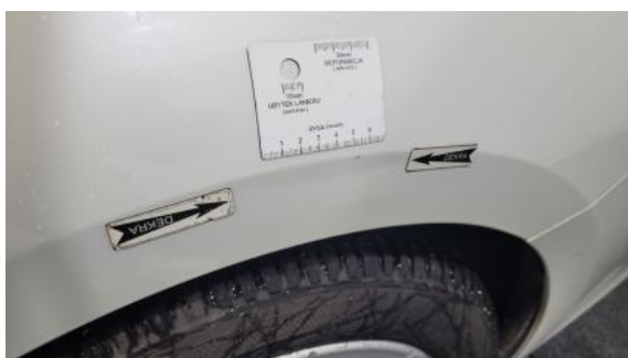
Fot. 39 Błotnik tylny L / Ściana boczna L - Wgniecenie/odkształcenie 1
