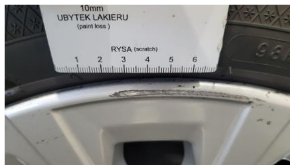
Fot. 34 Felga aluminiowa przednia P - Rysa/odprysk 1
