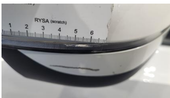
Fot. 35 Kierunkowskaz boczny/lusterka P - Rysa/odprysk 1
