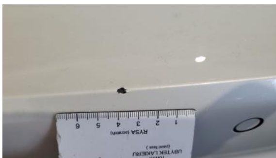
Fot. 37 Zderzak tylny - Rysa/odprysk 1
