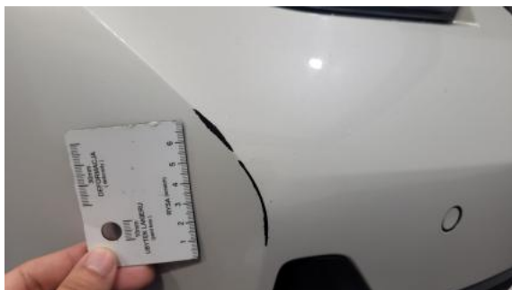
Fot. 33 Zderzak - Rysa/odprysk 1
