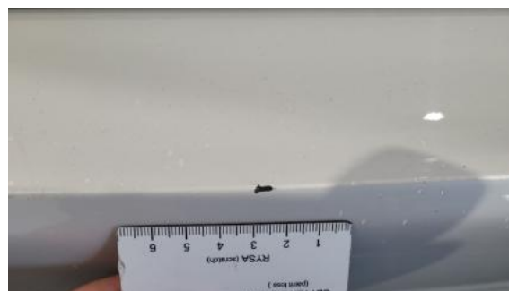
Fot. 38 Zderzak tylny - Rysa/odprysk 2
