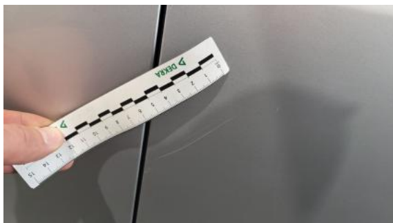
Fot. 41 Drzwi przednie P - Rysa/odprysk 1
