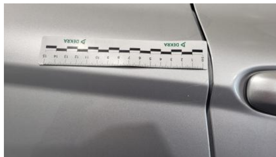
Fot. 42 Drzwi tylne P - Rysa/odprysk 1
