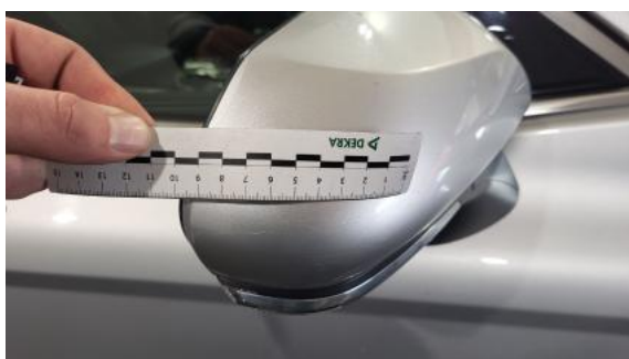
Fot. 43 Lusterko zew P - Rysa/odprysk 1
