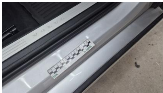
Fot. 46 Próg P - Rysa/odprysk 1
