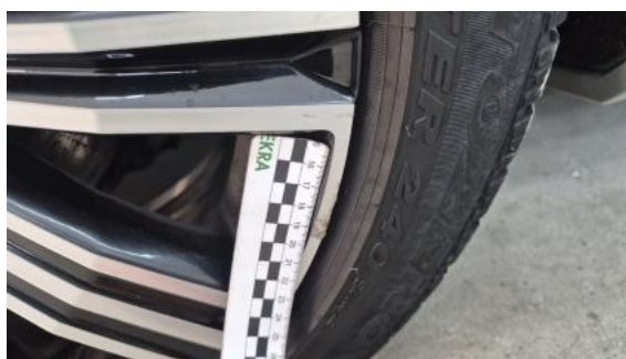
Fot. 48 Felga aluminiowa tylna P - Rysa/odprysk 1
