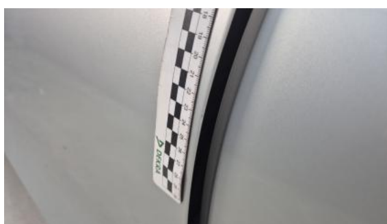
Fot. 52 Drzwi przed L - Rysa/odprysk 1
