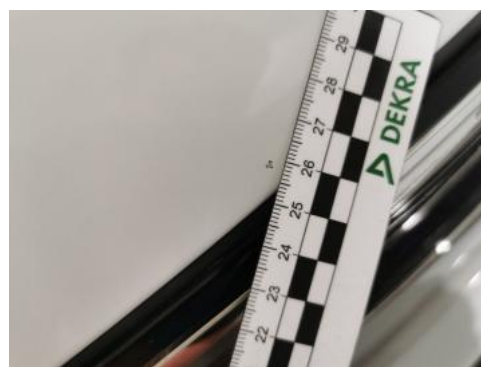
Fot. 38 Pokrywa komory silnika - Rysa/odprysk 1
