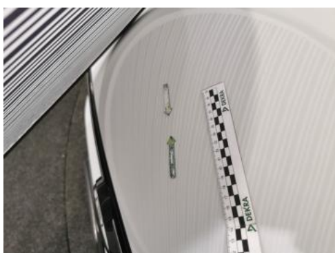
Fot. 39 Pokrywa komory silnika - Wgniecenie/odkształcenie 1
