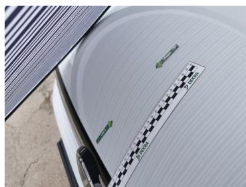
Fot. 40 Pokrywa komory silnika - Wgniecenie/odkształcenie 2
