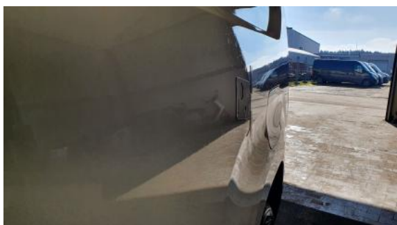
Fot. 45 Błotnik tylny L / Ściana boczna L - Wgniecenie/odkształcenie 2
