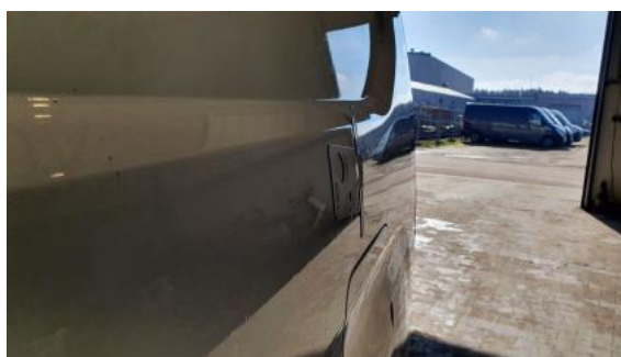
Fot. 44 Błotnik tylny L / Ściana boczna L - Wgniecenie/odkształcenie 1
