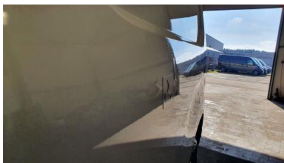
Fot. 46 Błotnik tylny L / Ściana boczna L() - Wgniecenie/odkształcenie 3
