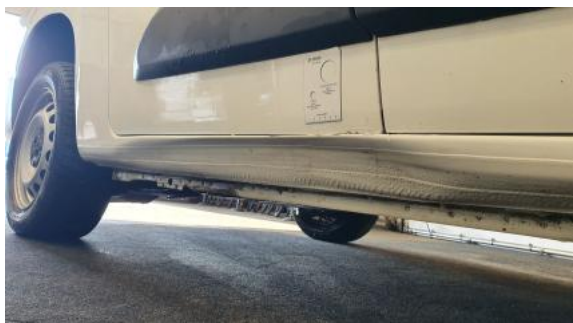
Fot. 41 Próg P - Wgniecenie/odkształcenie 1
