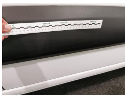
Fot. 36 Listwa drzwi przednich P - Rysa/odprysk 1
