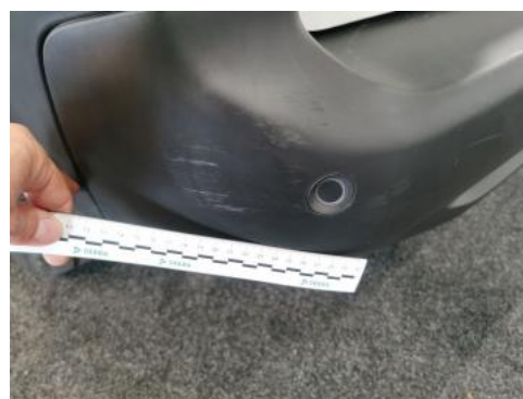
Fot. 38 Zderzak tylny - Rysa/odprysk 1
