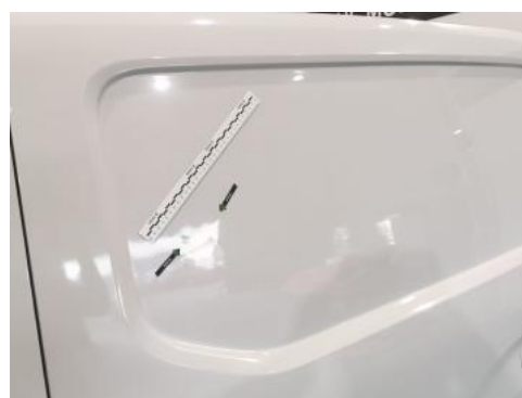
Fot. 40 Błotnik tylny L / Ściana boczna L - Wgniecenie/odkształcenie 1
