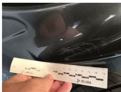
Fot. 56 Próg L - Rysa/odprysk 1
