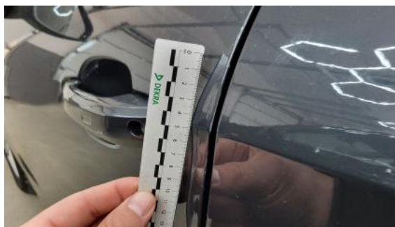
Fot. 40 Drzwi przed L - Rysa/odprysk 1
