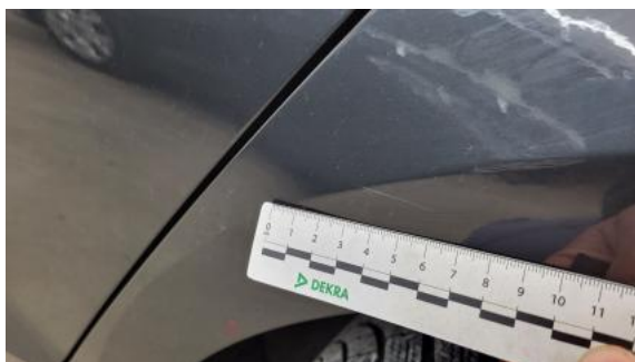
Fot. 37 Błotnik tylny L / Ściana boczna L - Rysa/odprysk 1
