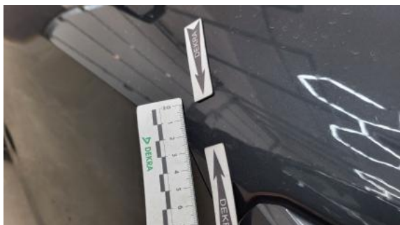
Fot. 41 Drzwi przed L - Wgniecenie/odkształcenie 1
