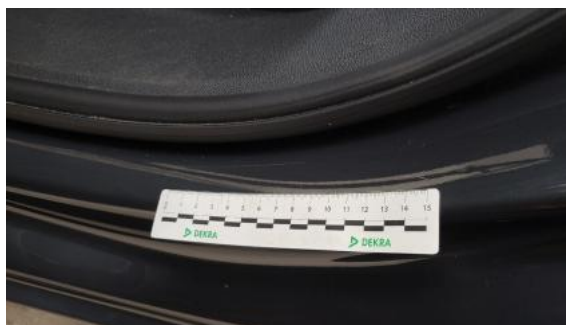
Fot. 38 Błotnik tylny L / Ściana boczna L - Rysa/odprysk 2
