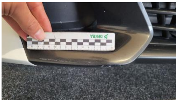
Fot. 33 Zderzak - Rysa/odprysk 1
