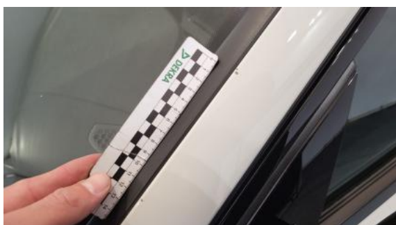
Fot. 39 Słupek przedni L - Rysa/odprysk 1
