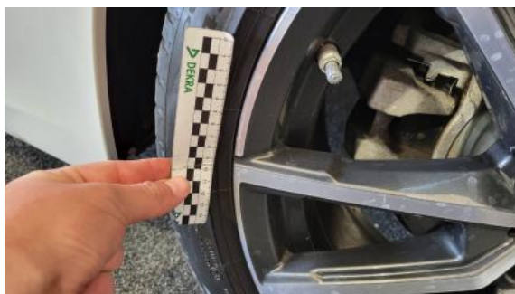
Fot. 37 Felga aluminiowa tylna L - Rysa/odprysk 1
