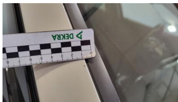
Fot. 36 Słupek przedni P - Rysa/odprysk 1
