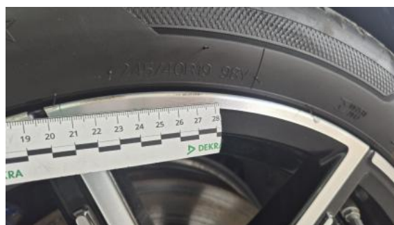
Fot. 40 Felga aluminiowa przednia P - Rysa/odprysk 1
