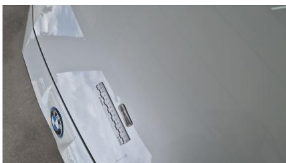
Fot. 39 Pokrywa komory silnika - Wgniecenie/odkształcenie 1
