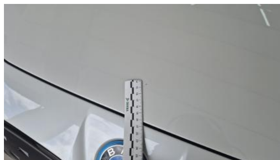
Fot. 38 Pokrywa komory silnika - Rysa/odprysk 1
