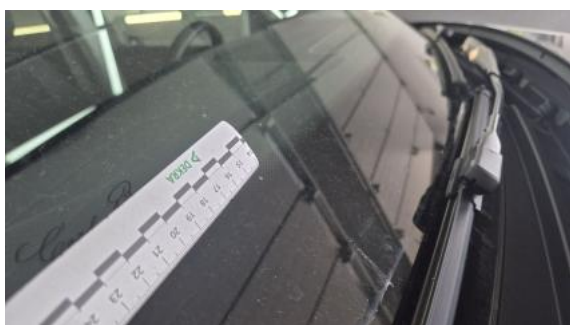
Fot. 39 Szyba czołowa - Rysa/odprysk 1
