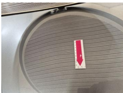
Fot. 37 Pokrywa komory silnika - Wgniecenie/odkształcenie 1
