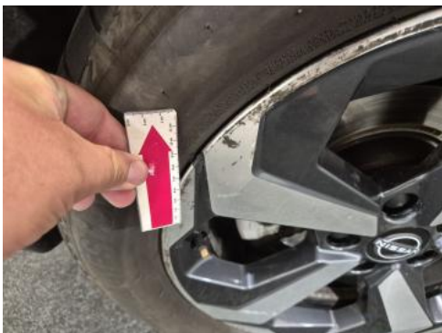
Fot. 41 Felga aluminiowa tylna P - Rysa/odprysk 1
