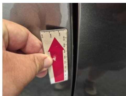
Fot. 40 Drzwi tylne P - Rysa/odprysk 1
