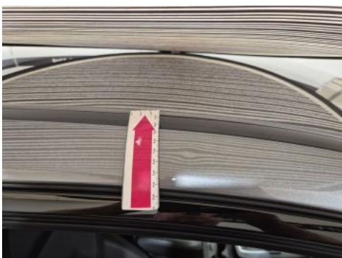
Fot. 45 Rama dachu P - Wgniecenie/odkształcenie 1
