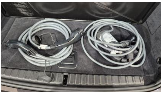
Fot. 27 Przewód ładowania baterii trakcyjnej
