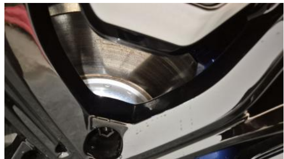
Fot. 28 Tarcza hamulcowa przednia lewa
