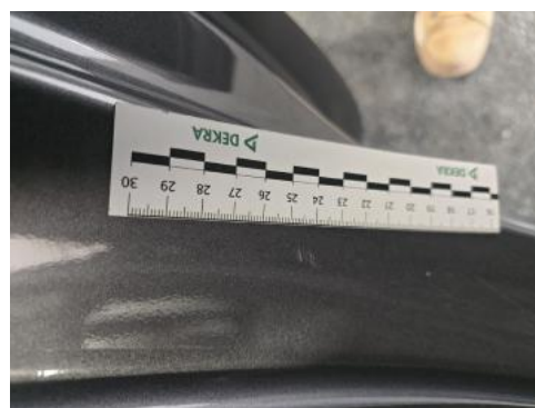
Fot. 46 Próg L - Rysa/odprysk 1
