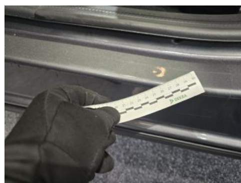
Fot. 48 Próg L() - Wgniecenie/odkształcenie 3
