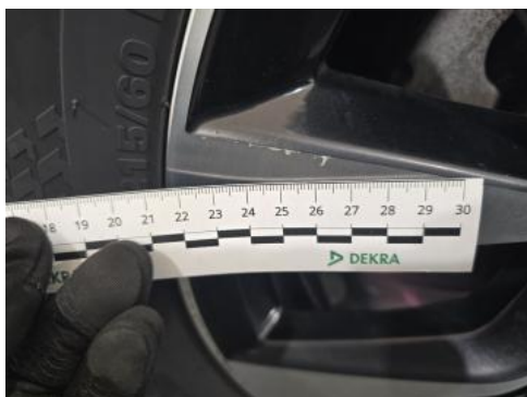
Fot. 41 Felga aluminiowa tylna P - Rysa/odprysk 1
