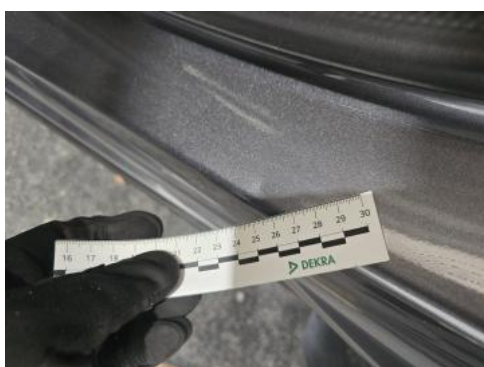
Fot. 47 Próg L - Wgniecenie/odkształcenie 1
