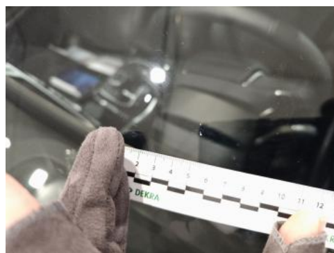
Fot. 36 Szyba czołowa - Rysa/odprysk 1
