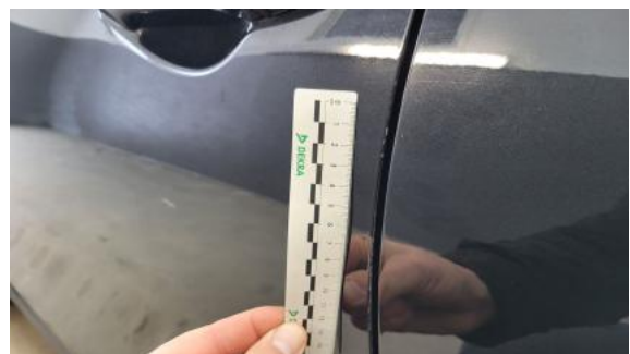
Fot. 38 Drzwi przed L - Rysa/odprysk 1
