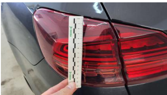
Fot. 37 Lampa tylna zew L - Rysa/odprysk 1
