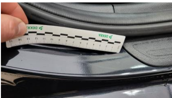
Fot. 35 Próg P - Rysa/odprysk 1
