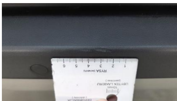
Fot. 40 Zderzak tylny - Rysa/odprysk 1
