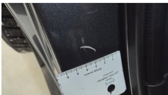
Fot. 39 Błotnik tylny P / Ściana boczna P - Rysa/odprysk 2
