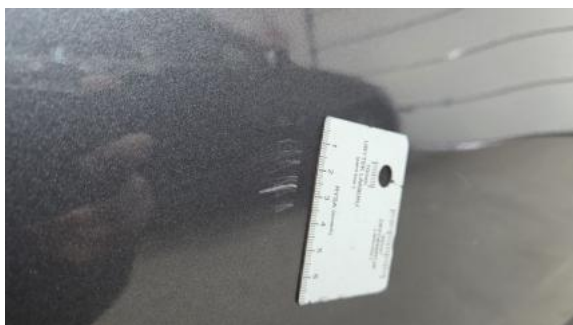
Fot. 37 Drzwi tylne P - Rysa/odprysk 1
