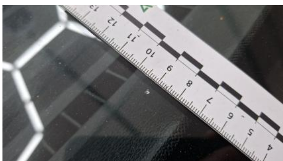
Fot. 39 Szyba czołowa - Rysa/odprysk 2
