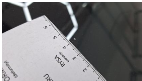
Fot. 38 Szyba czołowa - Rysa/odprysk 1
