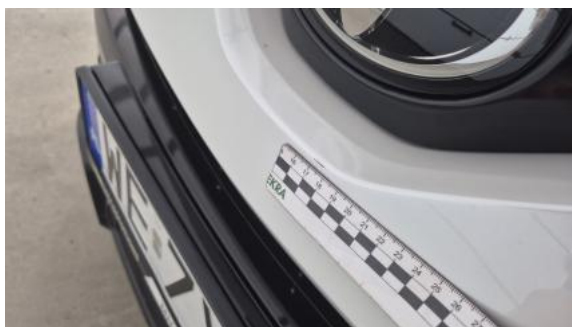
Fot. 37 Zderzak - Rysa/odprysk 1
