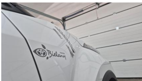
Fot. 39 Błotnik przedni P - Wgniecenie/odkształcenie 1
