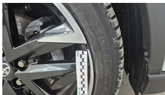
Fot. 40 Felga aluminiowa przednia P - Rysa/odprysk 1
