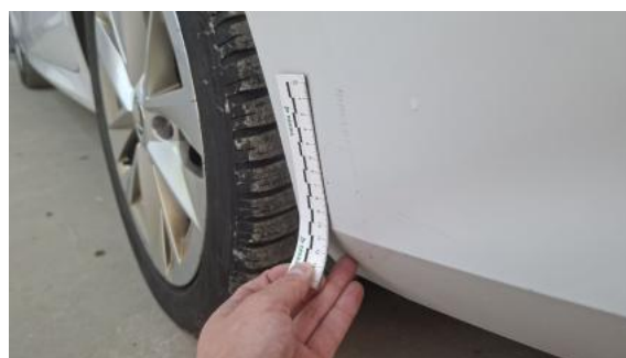
Fot. 48 Zderzak tylny cz L - Rysa/odprysk 1
