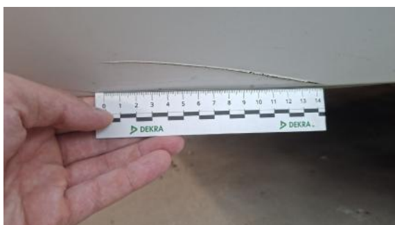
Fot. 51 Zderzak tylny cz P - Rysa/odprysk 1
