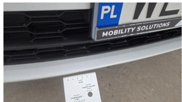
Fot. 36 Zderzak przedni cz dolna - Rysa/odprysk 1
