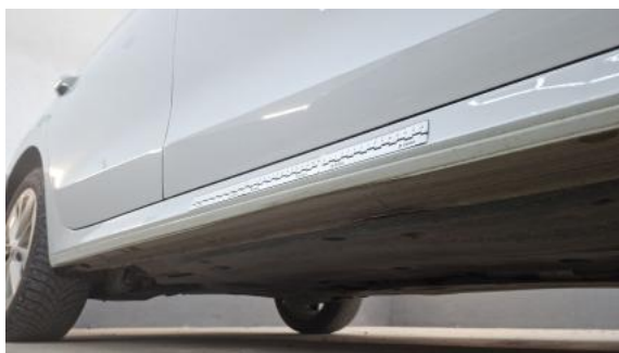
Fot. 45 Próg P - Wgniecenie/odkształcenie 2
