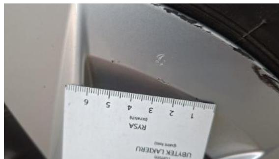
Fot. 42 Felga aluminiowa przednia P - Rysa/odprysk 1
