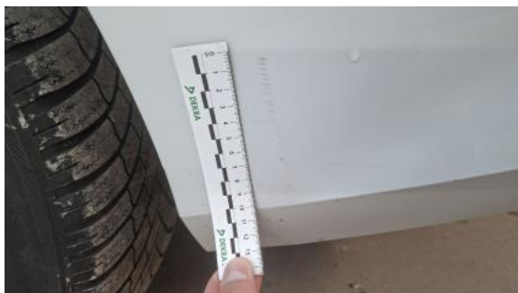
Fot. 49 Zderzak tylny cz L - Rysa/odprysk 2
