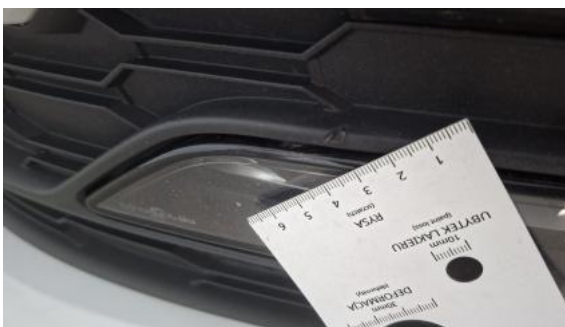
Fot. 39 Zderzak przedni cz L - Rysa/odprysk 1
