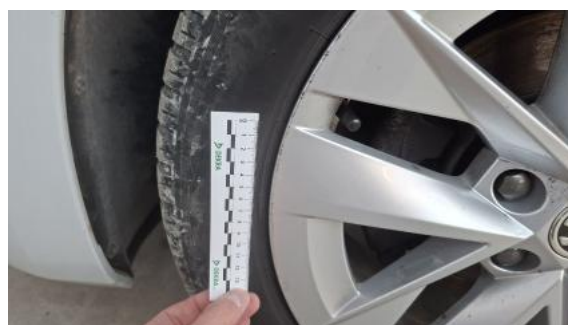
Fot. 56 Felga Aluminiowa przednia L - Rysa/odprysk 1
