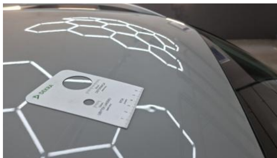
Fot. 58 Dach - Wgniecenie/odkształcenie 1
