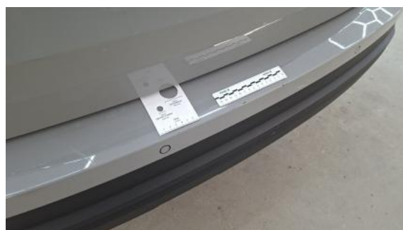
Fot. 56 Zderzak tylny() - Rysa/odprysk 3
