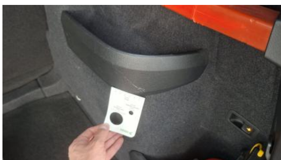
Fot. 67 Wykładzina przestrzeni bagażowej - Rysa/odprysk 1
