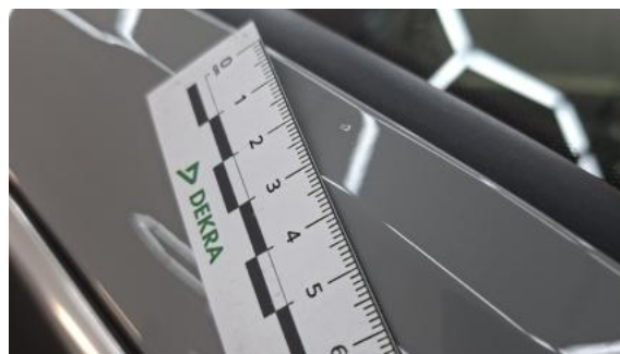
Fot. 46 Słupek przedni P - Rysa/odprysk 2
