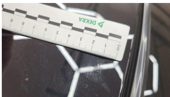
Fot. 40 Dach - Rysa/odprysk 2
