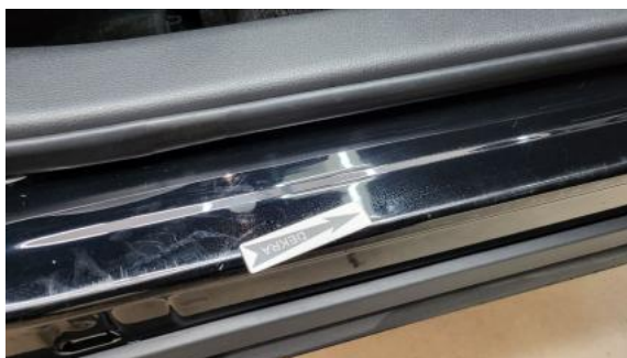
Fot. 37 Próg P - Wgniecenie/odkształcenie 2
