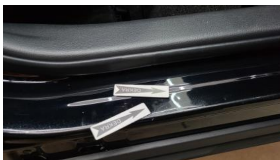
Fot. 36 Próg P - Wgniecenie/odkształcenie 1
