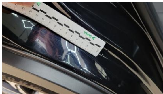
Fot. 38 Błotnik tylny P / Ściana boczna P - Rysa/odprysk 1
