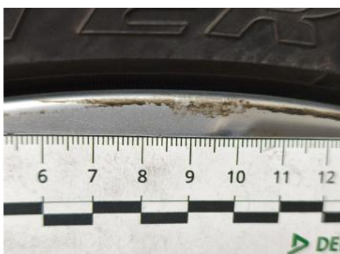
Fot. 43 Felga aluminiowa przednia P - Rysa/odprysk 1
