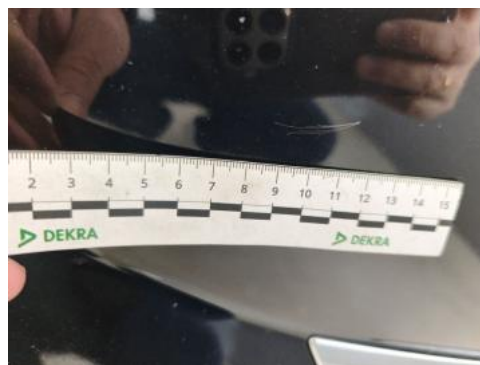
Fot. 42 Zderzak() - Rysa/odprysk 3
