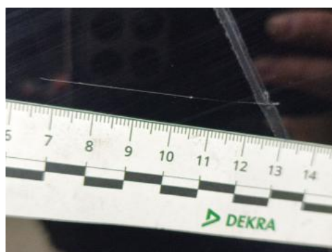
Fot. 44 Drzwi przednie P - Rysa/odprysk 1
