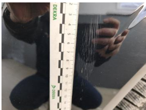
Fot. 41 Zderzak - Rysa/odprysk 1
