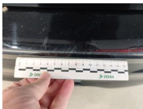
Fot. 48 Zderzak tylny - Rysa/odprysk 1
