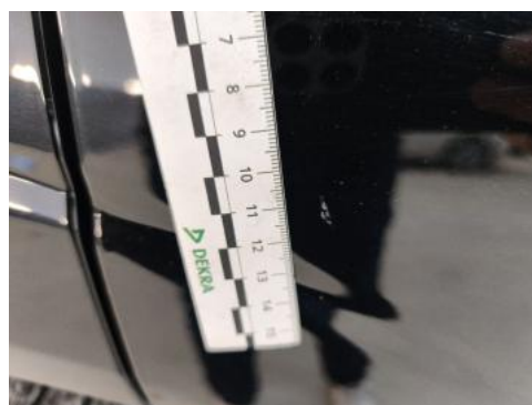
Fot. 46 Drzwi tylne P - Rysa/odprysk 2
