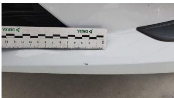
Fot. 35 Zderzak - Rysa/odprysk 1
