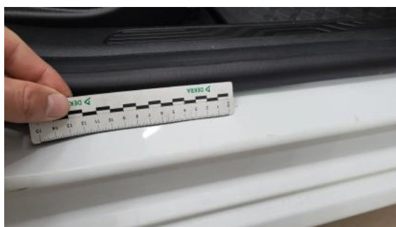
Fot. 36 Próg P - Rysa/odprysk 1
