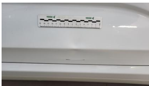
Fot. 40 Drzwi tylne L - Wgniecenie/odkształcenie 1
