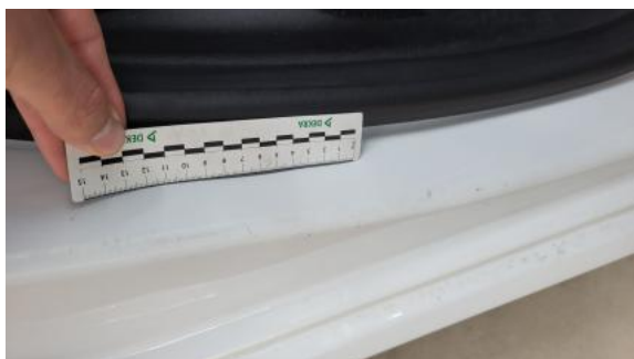
Fot. 37 Próg P - Rysa/odprysk 2
