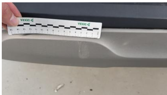
Fot. 38 Zderzak tylny cz śr - Rysa/odprysk 2
