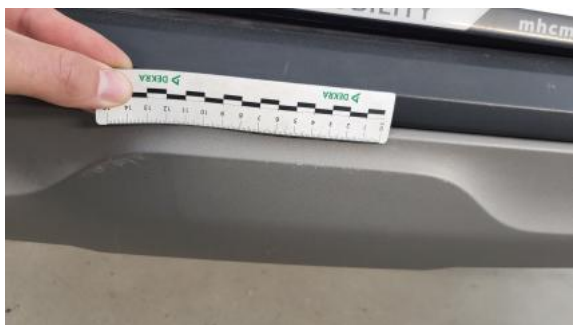
Fot. 37 Zderzak tylny cz śr - Rysa/odprysk 1
