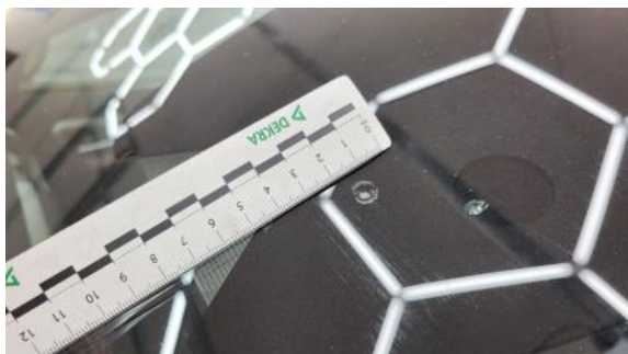
Fot. 33 Szyba czołowa - Pęknięcie/rozerwanie 2
