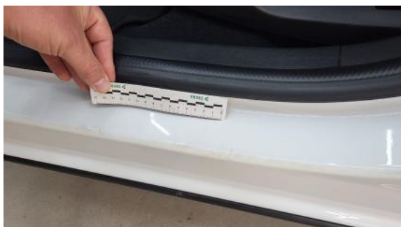
Fot. 39 Próg L - Rysa/odprysk 1
