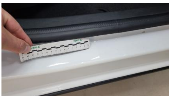
Fot. 35 Próg P - Rysa/odprysk 1
