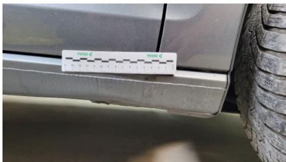
Fot. 41 Próg P - Wgniecenie/odkształcenie 1
