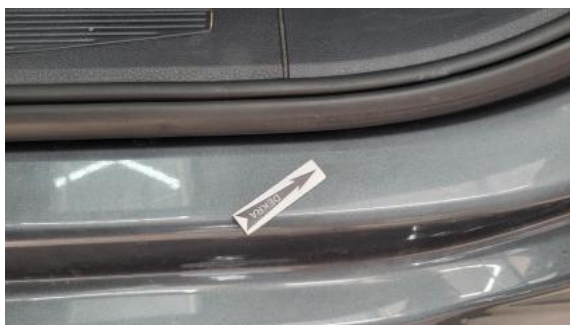
Fot. 45 Próg L - Wgniecenie/odkształcenie 1
