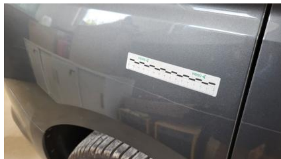
Fot. 42 Błotnik tylny P / Ściana boczna P - Rysa/odprysk 1
