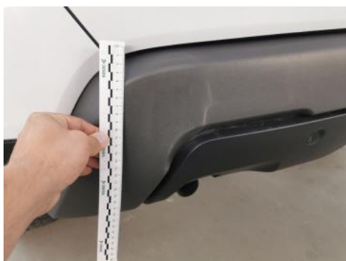
Fot. 47 Zderzak tylny - Wgniecenie/odkształcenie 1
