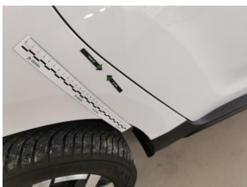
Fot. 43 Błotnik tylny P / Ściana boczna P - Wgniecenie/odkształcenie 1
