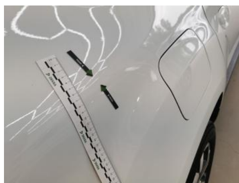
Fot. 44 Błotnik tylny P / Ściana boczna P - Wgniecenie/odkształcenie 2
