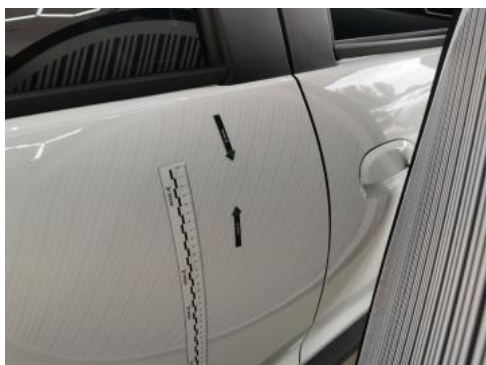
Fot. 41 Drzwi tylne P - Wgniecenie/odkształcenie 1
