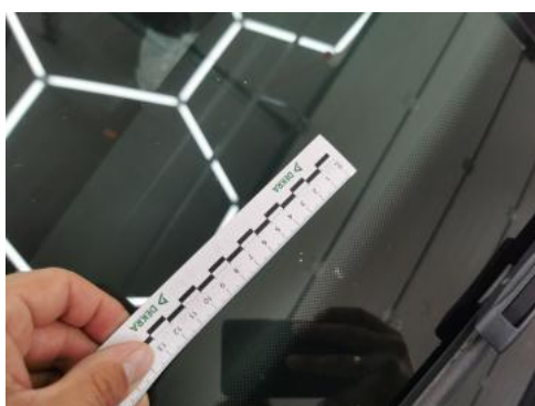
Fot. 39 Szyba czołowa - Rysa/odprysk 1
