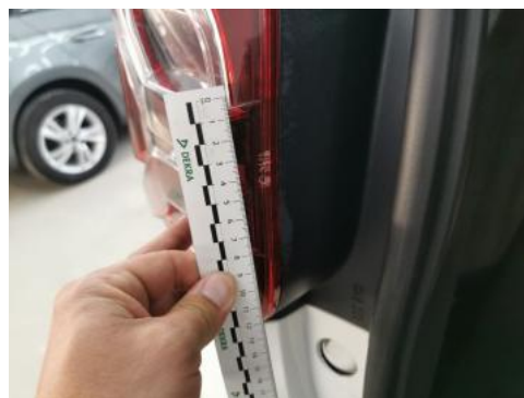
Fot. 50 Lampa tylna zew L - Pęknięcie/rozerwanie 1
