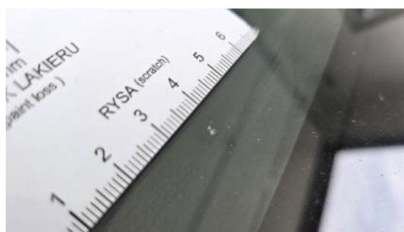
Fot. 44 Szyba czołowa() - Rysa/odprysk 3
